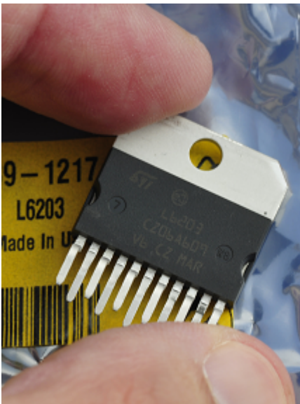
Pont en H 4A/48V/100Khz/0,3Ω
